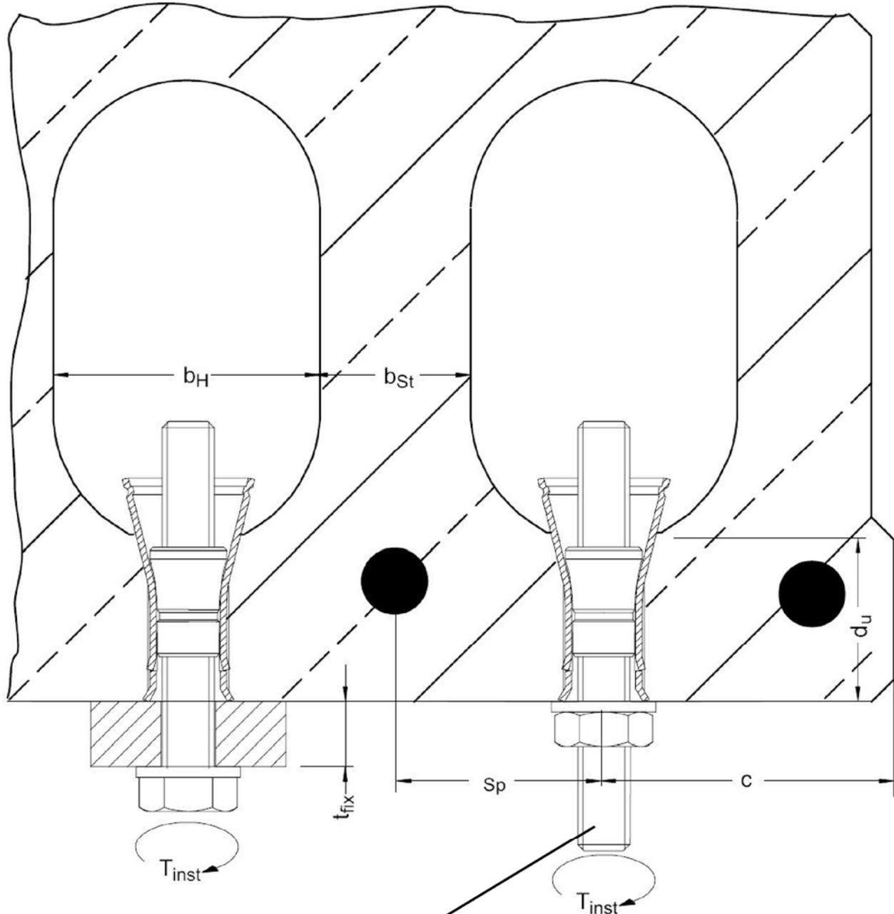
Gewinde für Anschluss z.B. einer Koppelmuffe
