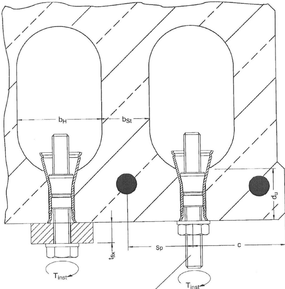
Gewinde für Anschluss z.B. einer Koppelmuffe
