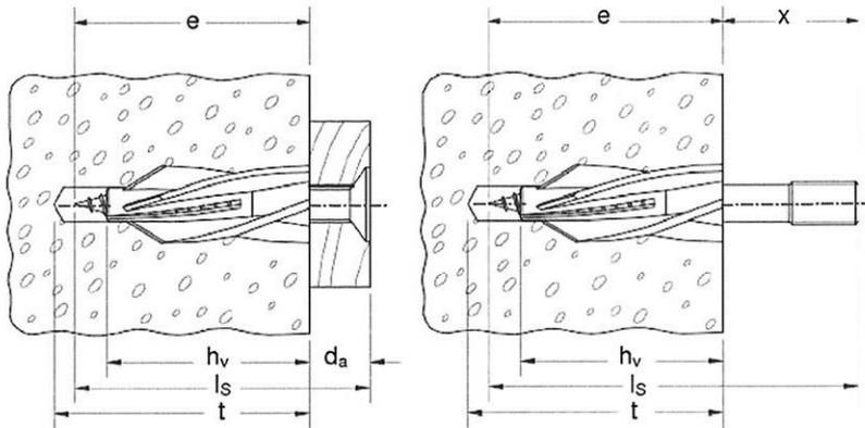
Die Mindestlauflänge  $l_s$  der Stockschraube ergibt sich aus der Einschraubtiefe  $e$  und dem Stehbolzenmaß  $x$ . Die Maximallänge der Stockschraube darf die Mindestlänge um folgendes Toleranzmaß nicht überschreiten:
