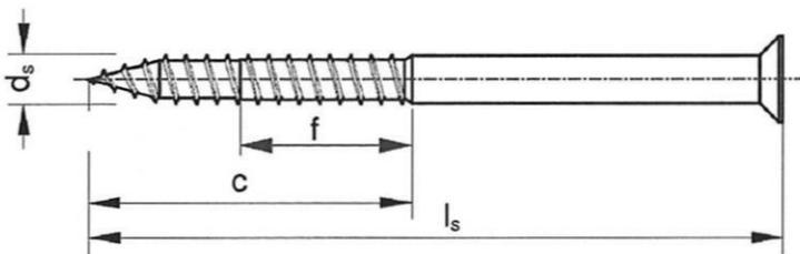
Schraube für  $d_s = 7\text{mm}$
