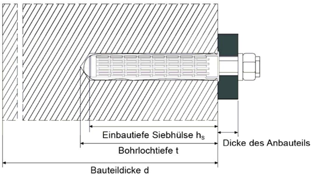
ATRION Verbundmörtelsystem AVM - MZ zur Verankerung im Mauerwerk
