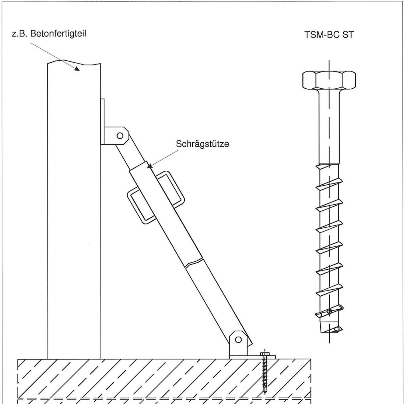
**TOGE Betonschraube TSM-BC ST**
