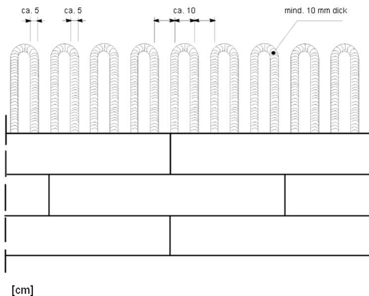
WDVS mit angeklebten und angedübelten Dämmstoffplatten
