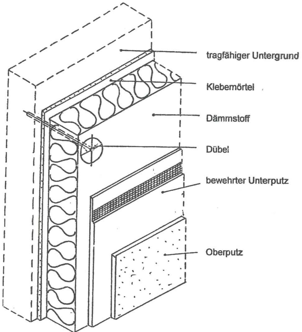
Wärmedämm-Verbundsysteme mit angedübeltem und angeklebtem Dämmstoff
