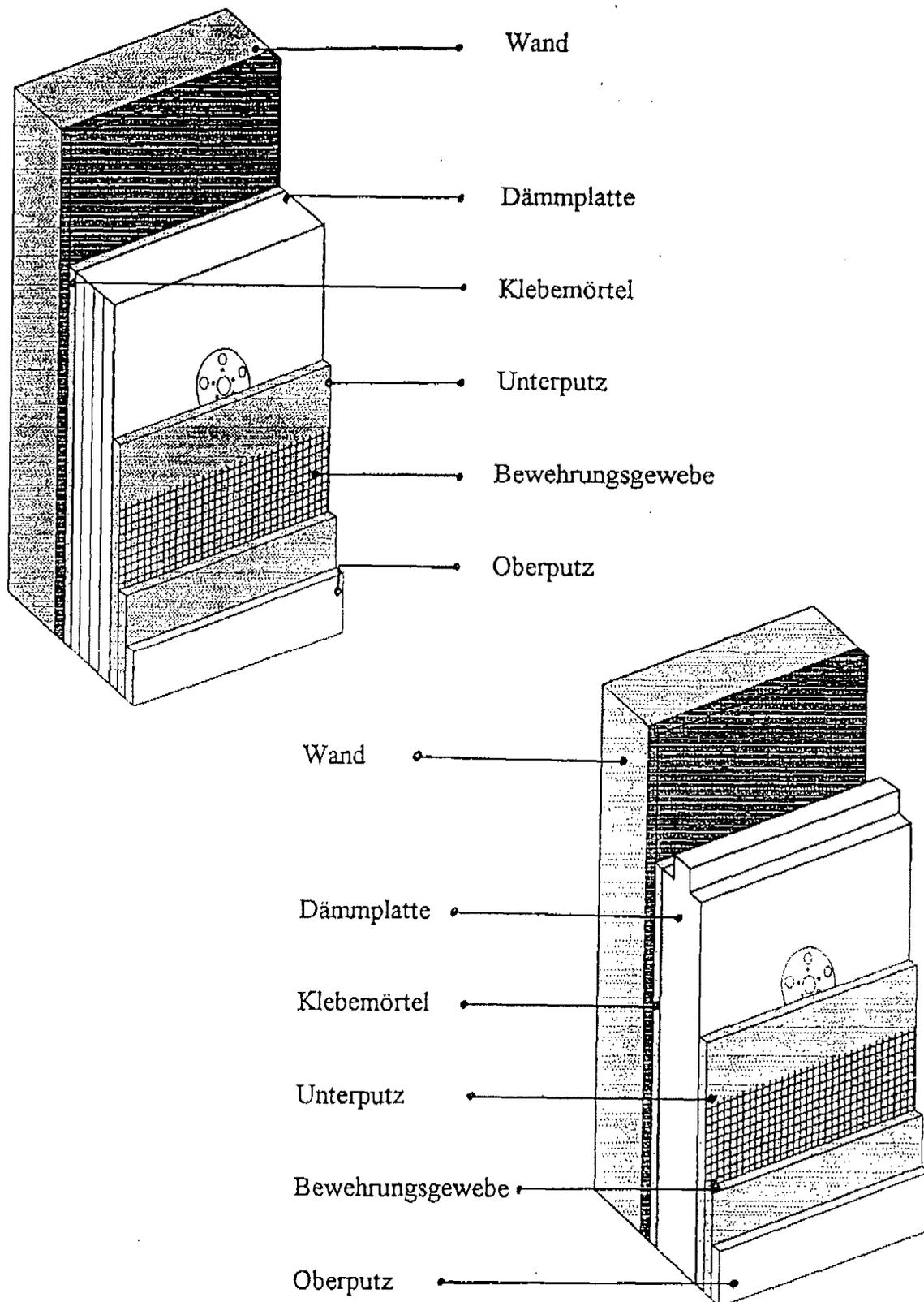
Wärmedämm-Verbundsystem mit angedübelten und angeklebten Dämmstoffplatten
