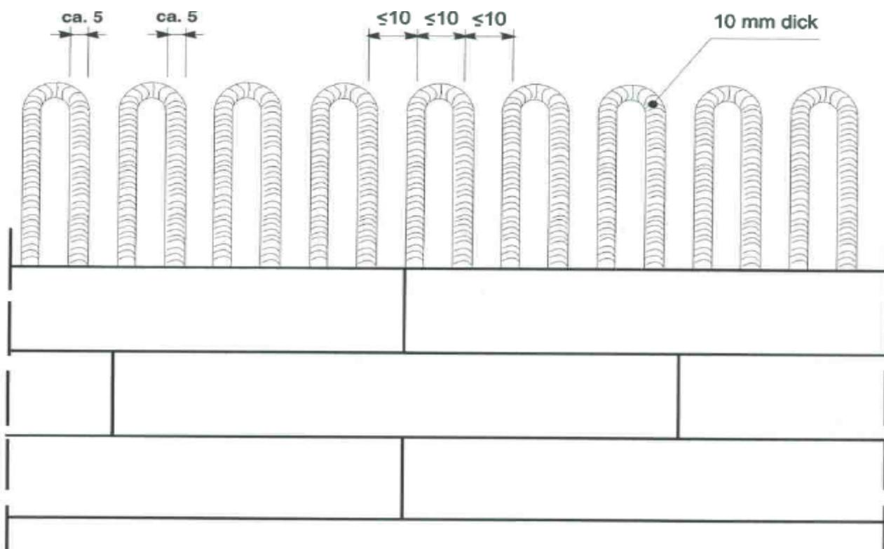
Wärmedämm-Verbundsystem mit angeklebten Mineralfaser-Lamellendämmplatten
