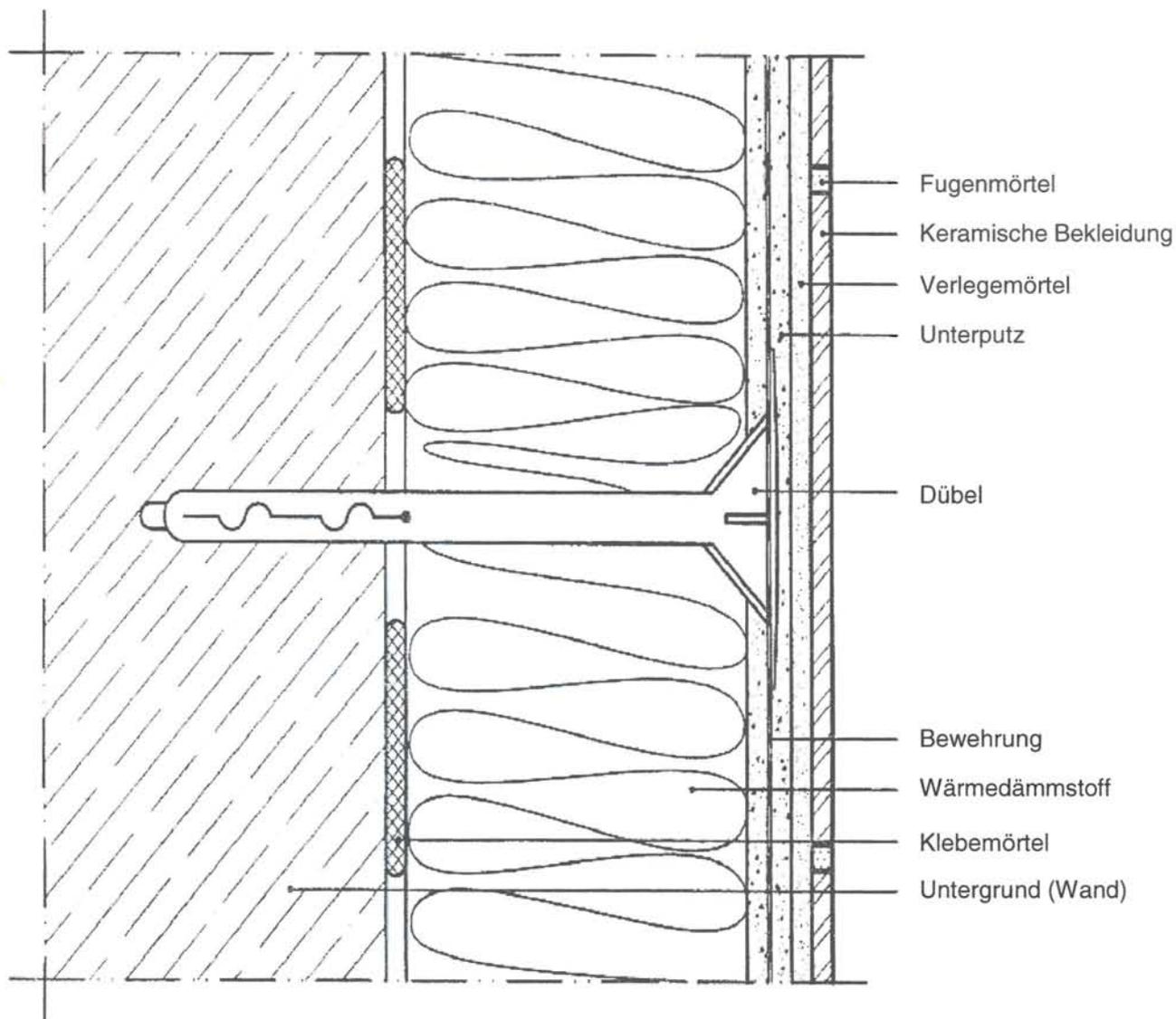
Wärmedämm-Verbundsystem mit angeklebter keramischer Bekleidung
