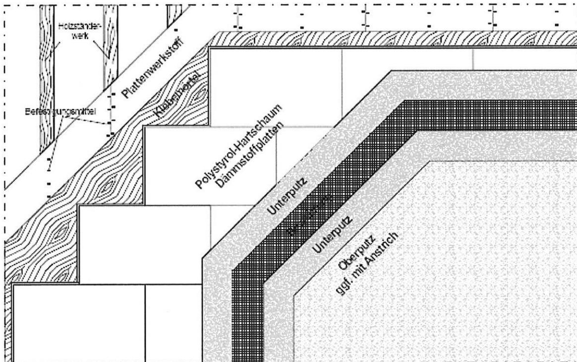
Wärmedämm-Verbundsystem zur Anwendung auf Plattenwerkstoffen im Holzbau mit angeklebten Dämmstoffplatten aus expandiertem Polystyrol
