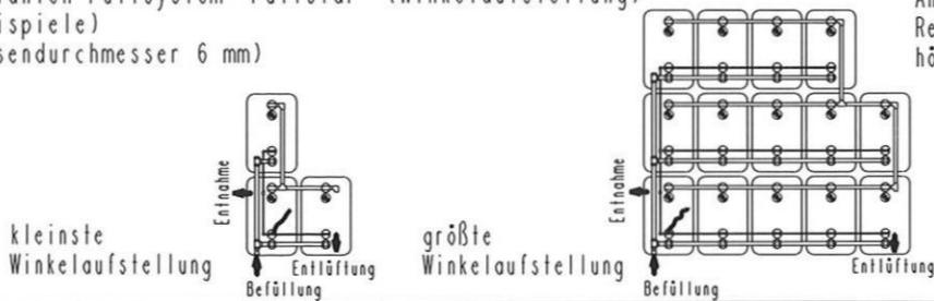
Anzahl der Behälter in hinteren Reihen (in Füllrichtung) darf nicht höher sein als in vorderer Reihe !
