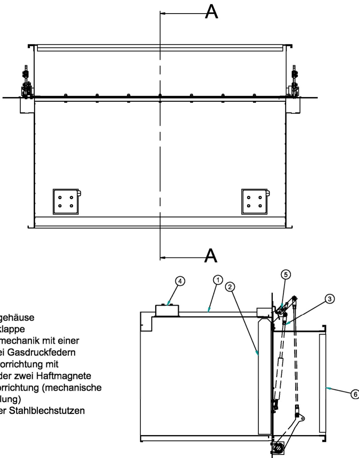
Absperrvorrichtungen gegen Feuer und Rauch in Lüftungsleitungen von gewerblichen Küchen, Typ "Firesafe II K90"
