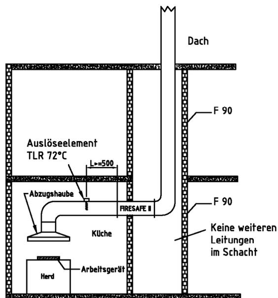
Absperrvorrichtungen gegen Feuer und Rauch in Lüftungsleitungen von gewerblichen Küchen, Typ "Firesafe II K90"
