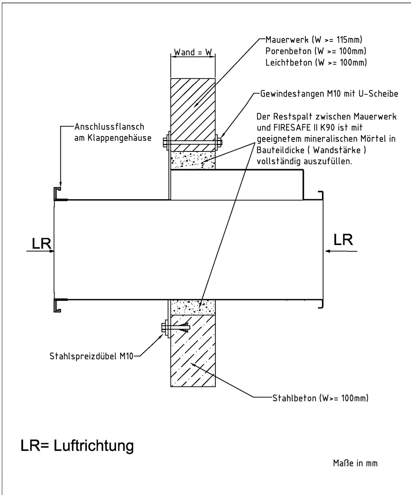
Absperrvorrichtungen gegen Feuer und Rauch in Lüftungsleitungen von gewerblichen Küchen, Typ "Firesafe II K90"
