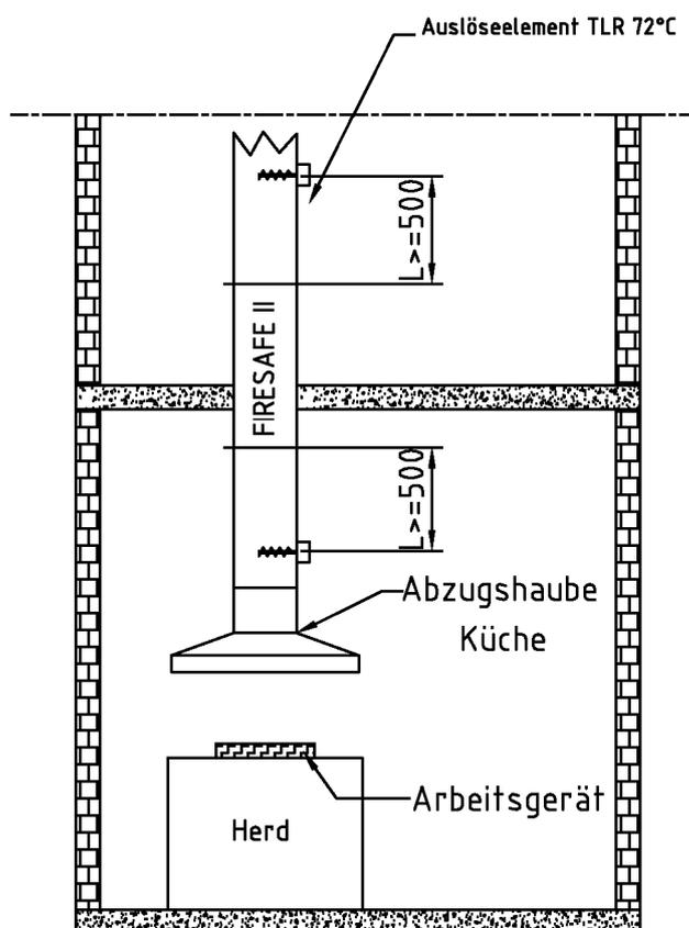
Absperrvorrichtungen gegen Feuer und Rauch in Lüftungsleitungen von gewerblichen Küchen, Typ "Firesafe II K90"
