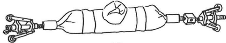
C. Voll aufgeblasener Packer mit installierter epros® DrainLCR-Hutmanschette
