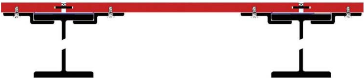
Balkenbodenplatte auf Stahlträger verdeckt befestigt (geschraubt)
