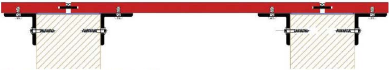
Balkenbodenplatte auf Holztram verdeckt befestigt (geschraubt)
