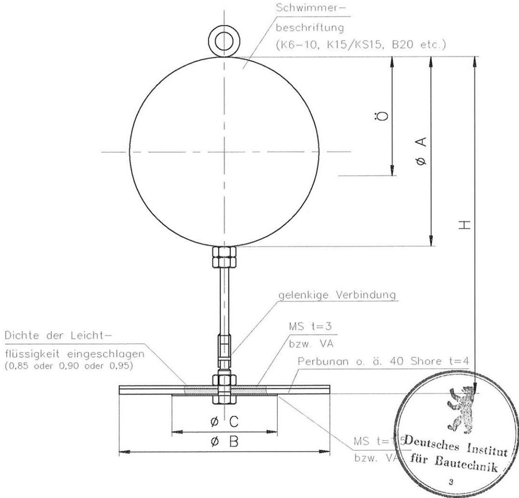
Maßtabelle für Leichtflüssigkeiten mit der Dichte  $<0,85$
