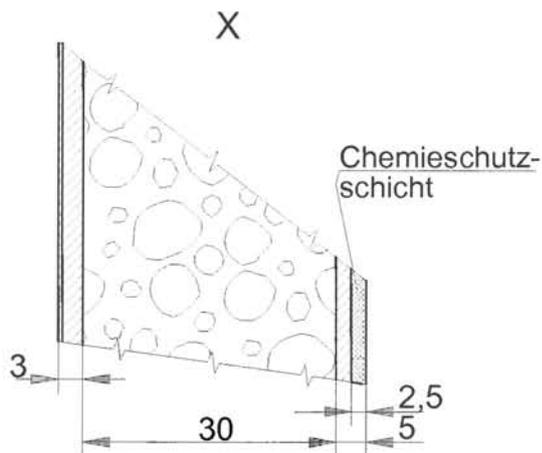
Die Chemieschutzschicht ist gleichwertig einer Innenbeschichtung nach DIN EN858-1.
