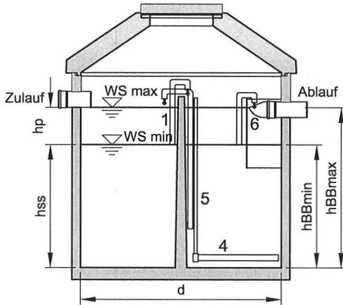
Schlamm-speicher + Puffer können eventuell auch als Mehrkammergrube ausgebildet sein (3- oder 4-Kammergrube)
