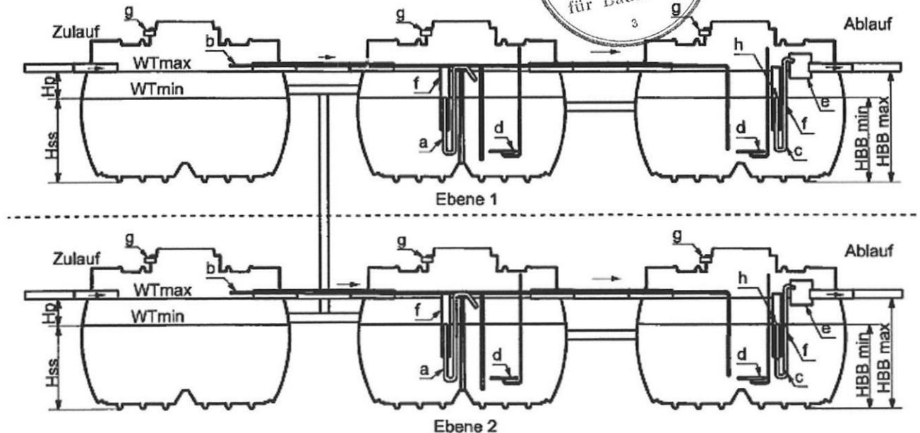
Herstellung: Rotationssinterverfahren; Werkstoff: PE
