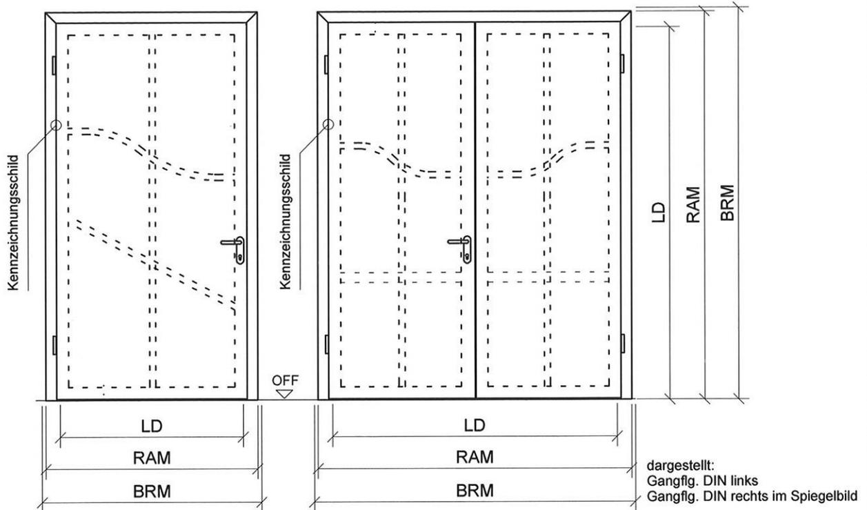
T30-1RS-FSA und T30-2-RS-FSA immer mit unterer Bodendichtung ausführen und Wandanschluss beids. versiegeln.
