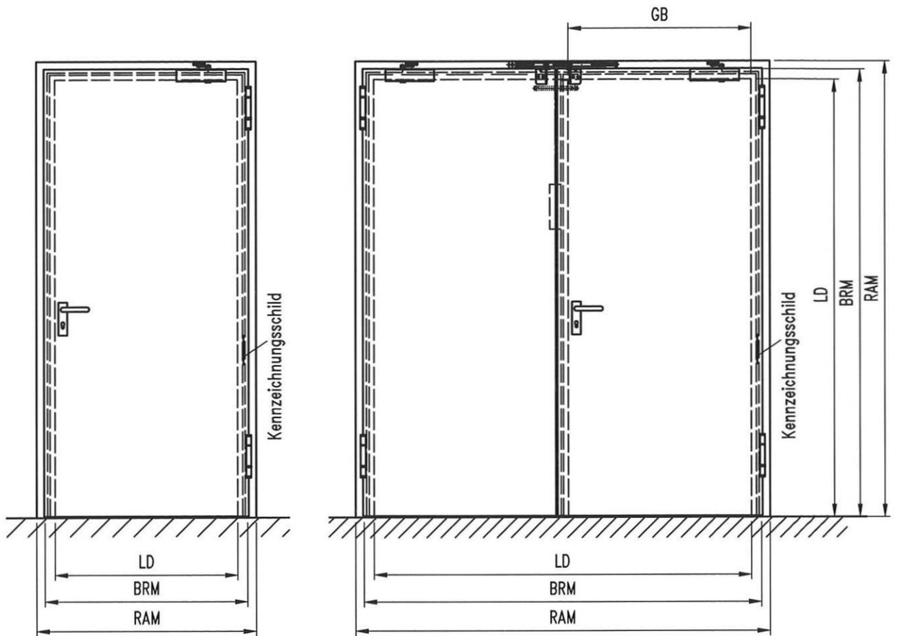
T90-1-RS-FSA und T90-2-RS-FSA immer mit absenkbarer Bodendichtung oder umlaufender Zargendichtung ausführen. Wandanschluss immer mind. auf Öffnungsseite (Bandseite) des FSA versiegeln !
