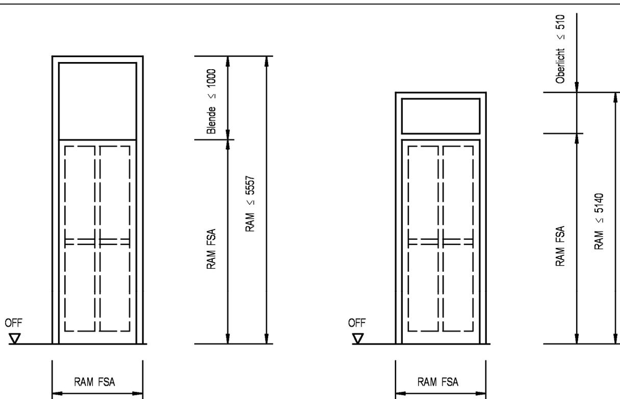
Kämpfer nur bei Stahlzarge in 1-flg. Ausführung und Brandschutzanforderung
