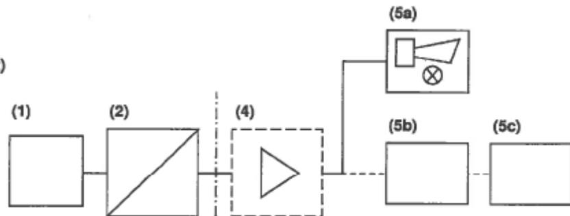
Standgrenzscharter (Kaltleiter) Typ BC-1 mit Messumformer als Anlagenteil von Überfüllsicherungen
