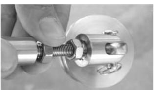
Zum Schluß wird durch das Drehen der Zugstange das Dach eingerichtet. Die Muttern müssen gekontert und mit Schraubensicherungsmasse gesichert werden.
