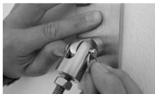
Die Zugstange wird in die obere Wandkonsole eingeschoben und mit dem Edelstahlbolzen befestigt. Anschließend wird der Bolzen mit einem Sicherungsring gesichert.
