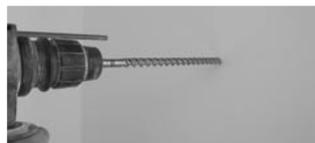
Die Bohrungen sind mit geeigneten Bohrwerkzeugen für die jeweiligen Befestigungsmittel, z.B. Sicherheitsanker, Verbundanker oder Injektionsdübel - abhängig von der Art des Mauerwerks - (gem. Herstellerangaben) zu setzen.\*
