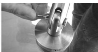
Die Zugstange wird in den vorderen Punkthalter eingeschoben und durch das Einstecken des Splintes in den Bolzen gesichert.
