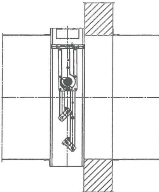
Einbau in Lüftungsleitungen
