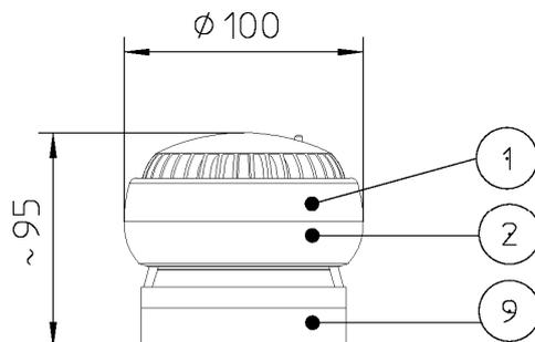
Gehäuse mit Netzteil
