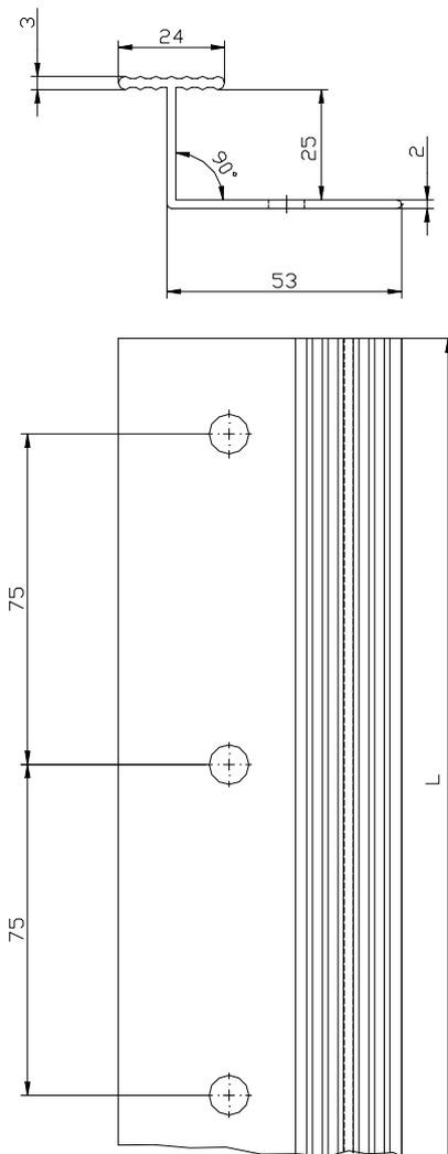
**Vertikales Verbindungsprofil "SAKRET Verbindungsschiene"** (Abmessungen in Millimetern)
