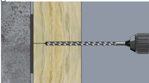
Erstellung des Bohrloches
