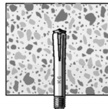
Der Dübel ist ordnungsgemäß verspreizt, wenn das Setzwerkzeug auf der Betonoberfläche aufliegt.
