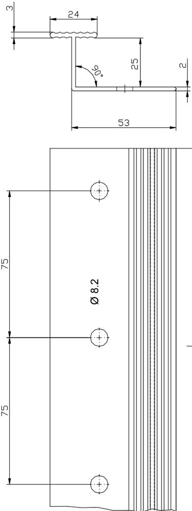
**Vertikales Halteprofil - "Sto-Verbindungsleiste PVC" (Maße in mm)**
