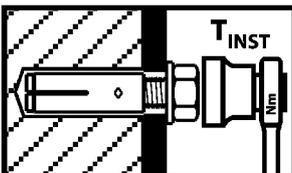
Montagemoment  $T_{inst}$  mit Drehmomentschlüssel aufbringen.
