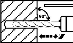
Bohrloch senkrecht zur Oberfläche des Verankerungsgrunds erstellen.
