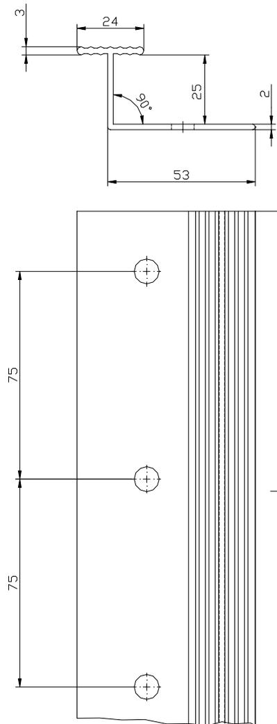
**Vertikales Verbindungsprofil "PVC Verbindungsleiste" (Maße in mm)**
