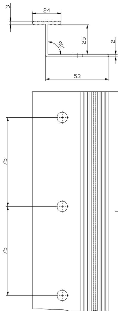
**Vertikales Verbindungsprofil "Brillux WDVS Verbindungsleiste 3544" (Maße in mm)**
