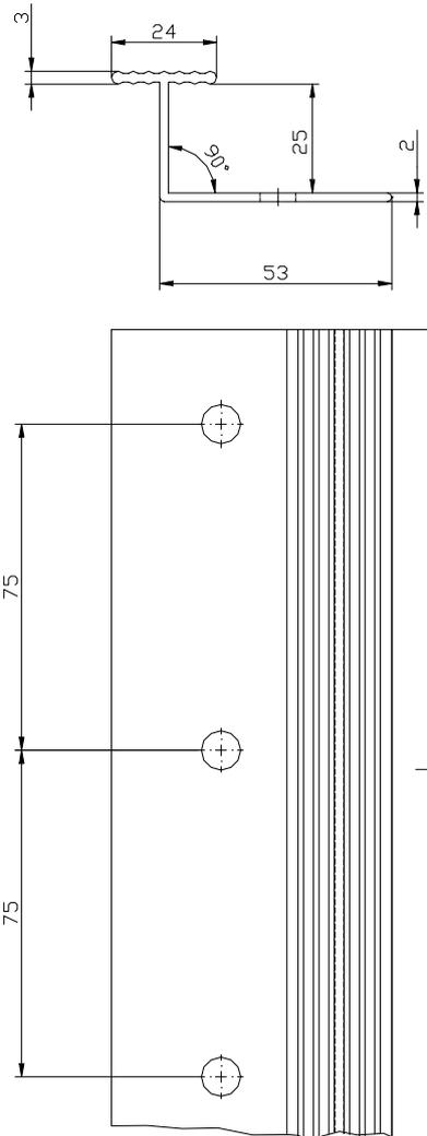
**Vertikales Verbindungsprofil "Verbindungsleiste PVC" (Maße in mm)**
