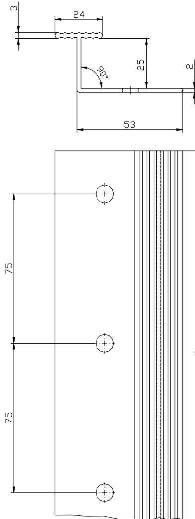
**Vertikales Verbindungsprofil "Verbindungsleiste PVC" (Maße in mm)**
