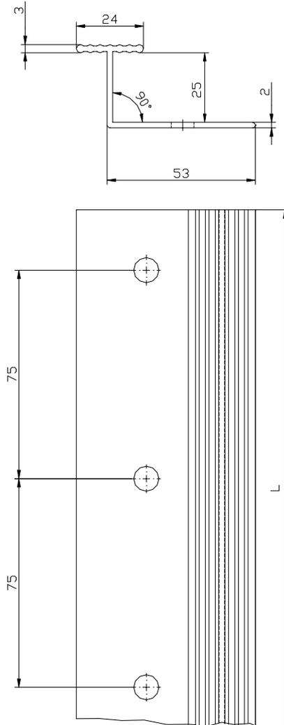
**Vertikales Verbindungsprofil "HAERING Verbindungsleiste PVC" (Maße in mm)**
