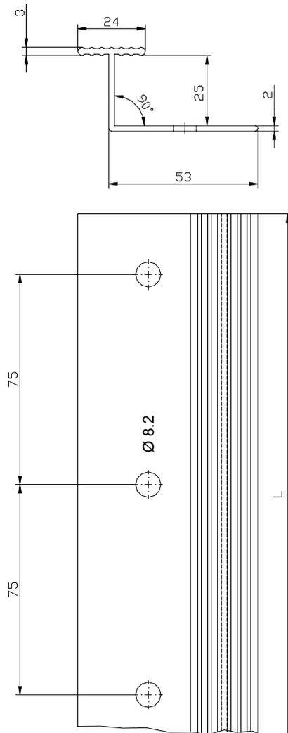
**Vertikales Verbindungsprofil "Verbindungsleiste PVC" (Maße in mm)**
