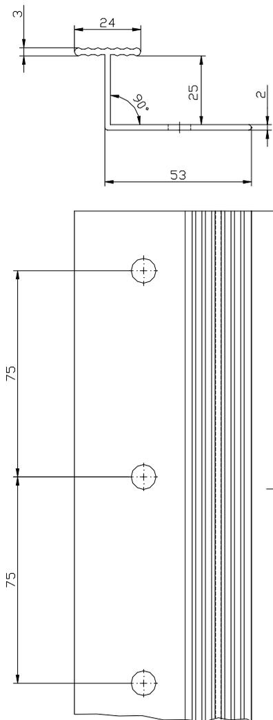
**Vertikales Verbindungsprofil "Verbindungsleiste PVC" (Maße in mm)**
