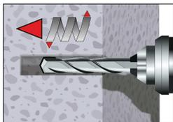
1. Bohrloch drehschlagend mit vorgeschriebenem Bohrerdurchmesser (Tabelle 2 oder Tabelle 3) und gewählter Bohrtiefe erstellen.
