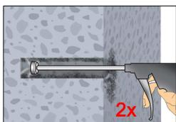
**Achtung! Vor der Reinigung muss im Bohrloch stehendes Wasser entfernt werden.**
