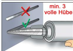
5. Der Mörtelvorlauf ist nicht zur Befestigung der Ankerstange geeignet. Daher Vorlauf solange verwerfen, bis sich eine gleichmäßig graue oder rote Mischfarbe eingestellt hat, jedoch min. 3 volle Hübe.
