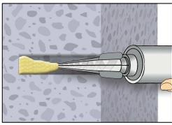
6. Gereinigtes Bohrloch vom Bohrlochgrund her ca. zu 2/3 mit Verbundmörtel befüllen. Langsames Zurückziehen des Statikmischers aus dem Bohrloch verhindert die Bildung von Luftschlüssen. Für Setztiefen größer 190 mm passende Mischerverlängerung verwenden. Für die Horizontal- oder Überkopfmontage von Ankern > Ø 20 mm sind Verfüllstützen gemäß Anhang 8 zu verwenden. Die temperaturrelevanten Verarbeitungszeiten (Tabelle 4) sind zu beachten.
