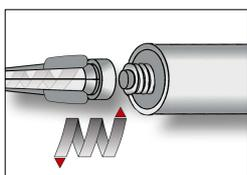
3. Den mitgelieferten Statikmischer fest auf die Kartusche aufschrauben und Kartusche in eine geeignete Auspresspistole einlegen. Bei jeder Arbeitsunterbrechung länger als die empfohlene Verarbeitungszeit (Tabelle 4) und bei jeder neuen Kartusche ist der Statikmischer zu erneuern.
