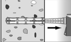
Mit Injektionsmörtel FIS PM durch die Power Sleeve hindurch
