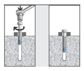
Platzieren des Anbauteiles und setzen des Dübels
