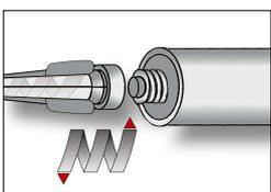
3. Den mitgelieferten Statikmischer fest auf die Kartusche aufschrauben und Kartusche in eine geeignete Auspresspistole einlegen. Den Schlauchfolienclip vor der Verwendung abschneiden.
