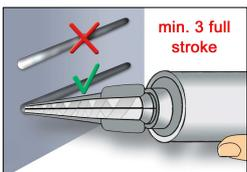
5. Der Mörtelvorlauf ist nicht zur Befestigung der Ankerstange geeignet. Daher Vorlauf solange verwerfen, bis sich eine gleichmäßig graue Mischfarbe eingestellt hat, jedoch min. 3 volle Hübe. Bei Schlauchfoliengebänden sind min. 6 volle Hübe zu verwerfen.
