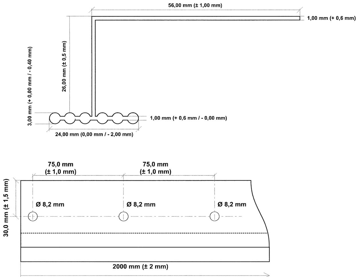
**Vertikales Verbindungsprofil – "Sto-Verbindungsleiste Alu"**
