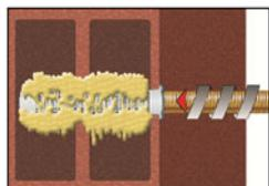
7. Vor dem Einsetzen der Ankerstange ist die Setztiefe auf der Ankerstange zu markieren. Befestigungselement mit leichten Drehbewegungen, zur optimalen Verteilung des Mörtels, bis zur festgelegten Setztiefe einführen. Die Ankerstange sollte fett-, öl- und schmutzfrei sein.
