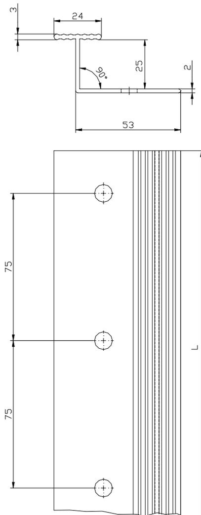
**Vertikales Verbindungsprofil "Sto-Verbindungsleiste PVC"** (Abmessungen in Millimetern)
