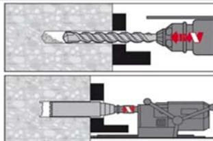
**Durchsteckmontage:** Bohrloch durch das Durchgangsloch im anschließenden Bauteil mit Bohrhammer drehschlagend, unter Verwendung des passenden Bohrerdurchmessers auf die richtige Bohrtiefe erstellen.
