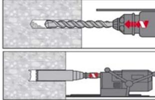
**Vorsteckmontage:** Bohrloch mit Bohrhammer drehschlagend, unter Verwendung des passenden Bohrerdurchmessers auf die richtige Bohrtiefe erstellen.
