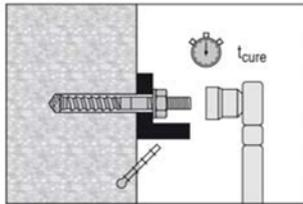
Nach Ablauf der erforderlichen Aushärtezeit  $t_{cure}$  (siehe Tabelle 4) kann der überstehende Mörtel entfernt und das erforderliche Installationsdrehmoment  $T_{inst}$  (siehe Tabelle 2) aufgebracht werden. Anschließend kann der Anker belastet werden.
