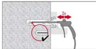
Bohrloch 2-mal mit ölfreier Druckluft (min. 6 bar bei 6m<sup>3</sup>/h) zum Entfernen des Wassers ausblasen
