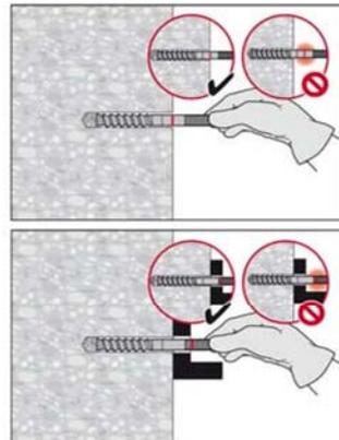
Befestigungselement markieren, Setztiefe kontrollieren und Bohrmehl verdichten. Die Ankerstange muss bis zur Setztiefenmarkierung in das Bohrloch passen.
