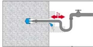
Bohrloch 2-mal vom Bohrlochgrund über die gesamte Länge mit ausspülen
