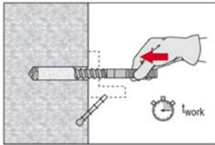
Vor der Montage sicherstellen, dass das Element trocken und frei von Öl und anderen Verunreinigungen ist. Element bis zur gewünschten Verankerungstiefe einführen, noch bevor die Verarbeitungszeit  $t_{work}$  (siehe Tabelle 4) abgelaufen ist. Nach dem Einsetzen des Befestigungselementes muss der Ringspalt zwischen Element und Anbauteil (Durchsteckmontage) oder Element und Beton (Vorsteckmontage) ausgefüllt sein.
