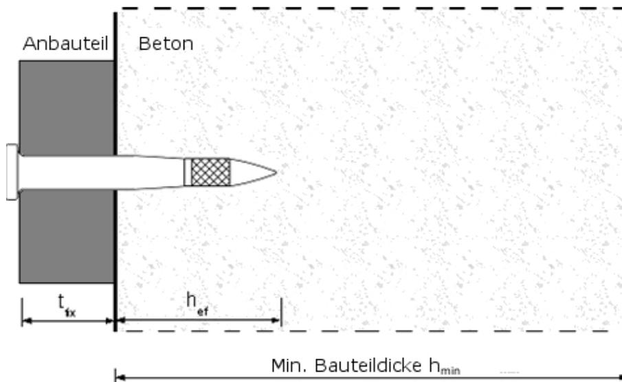
**Der Setzbolzen darf nur für die Mehrfachbefestigung von nichttragenden Systemen verwendet werden, die Definition der Mehrfachbefestigung ist im Abschnitt 4.2 dieser Zulassung angegeben.**
