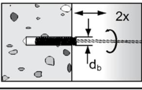
**2x** Bohrloch zweimal mit passender Stahlbürste ausbürsten.
