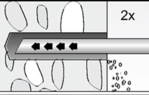
**2x** Bohrlochreinigung: Bohrloch zweimal mit
