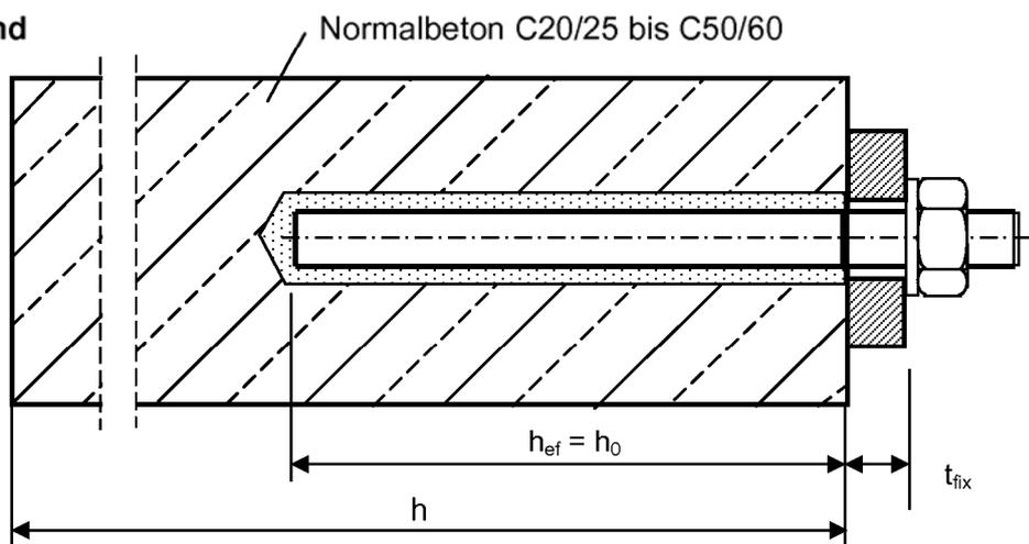
Nutzungskategorie: - Einbau im trockenen oder nassen Beton, nicht in wassergefüllte Bohrlöcher
