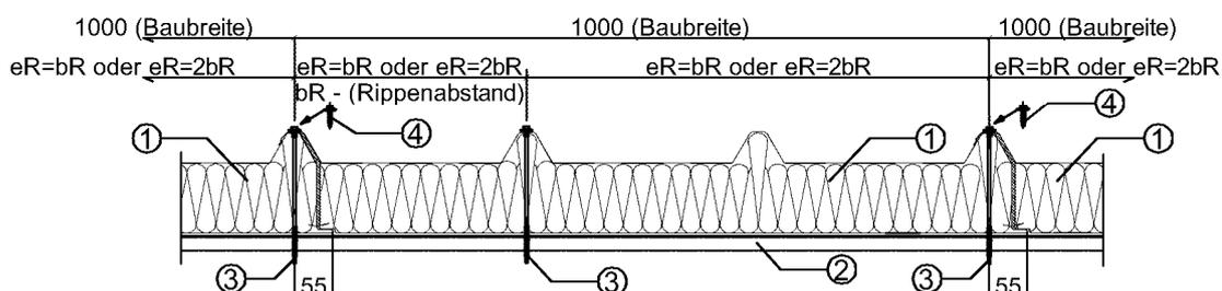
Schraubenabstände parallel zur Spannrichtung
