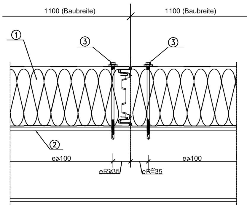
Schraubenabstände parallel zur Spannrichtung
