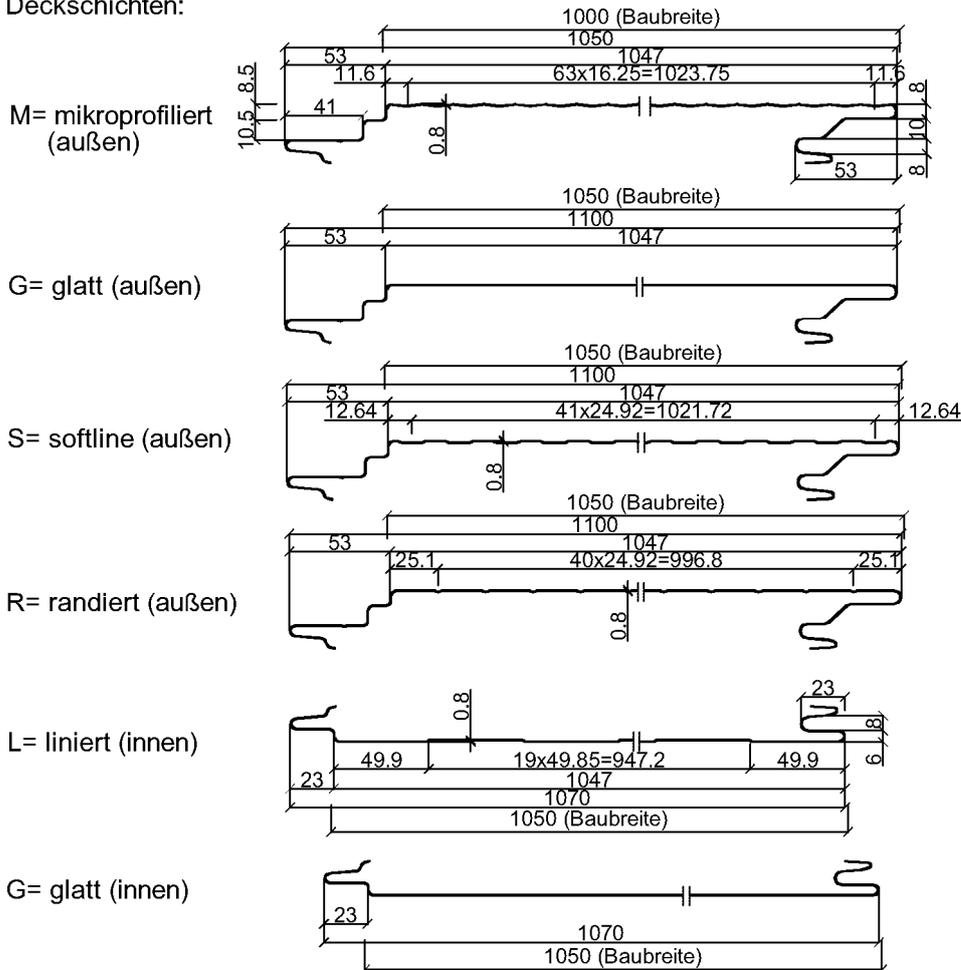
$t_N$ : Nennblechdicke der Deckschichten (Dicke einschließlich Zinkauflage)
