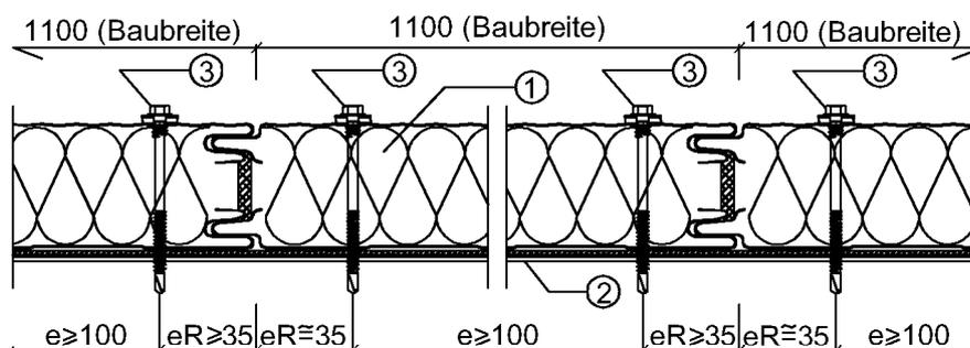
Schraubenabstände parallel zur Spannrichtung
