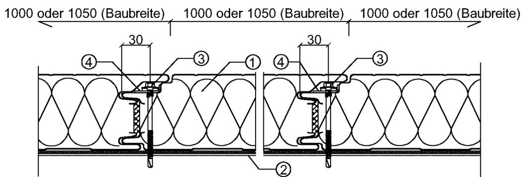
Schraubenabstände parallel zur Spannrichtung
